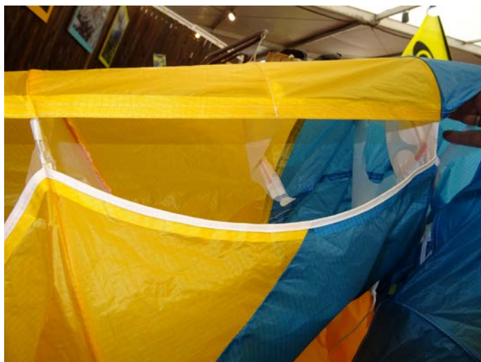
Mini-Ribs dans le bord d'attaque.
