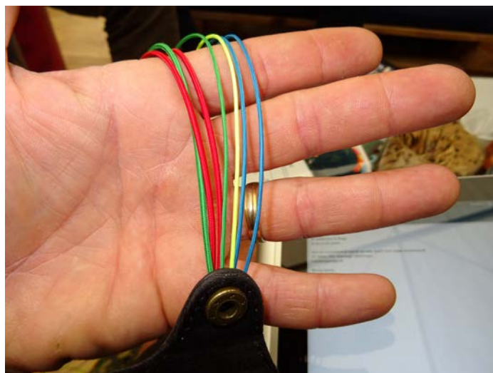
Les suspentes de diamètres différents, même sur une même rangée
