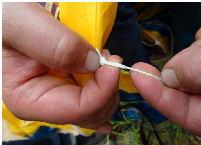
À l'intérieur de l'épaisseur formant la boucle de cette suspente fine, une âme pour une meilleure résistance de l'ensemble.
