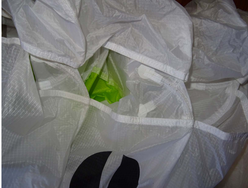
Les tissus sont un mix de Skytex 38 g/m 2 et de Dominico D20 35 g/m 2 , et la fabrication est plus costaud que légère. Photo : S. Burkhardt
