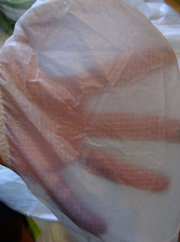
Les tissus sont un mix de Skytex 38 g/m 2 et de Dominico D20 35 g/m 2 , et la fabrication est plus costaud que légère. Photo : S. Burkhardt
