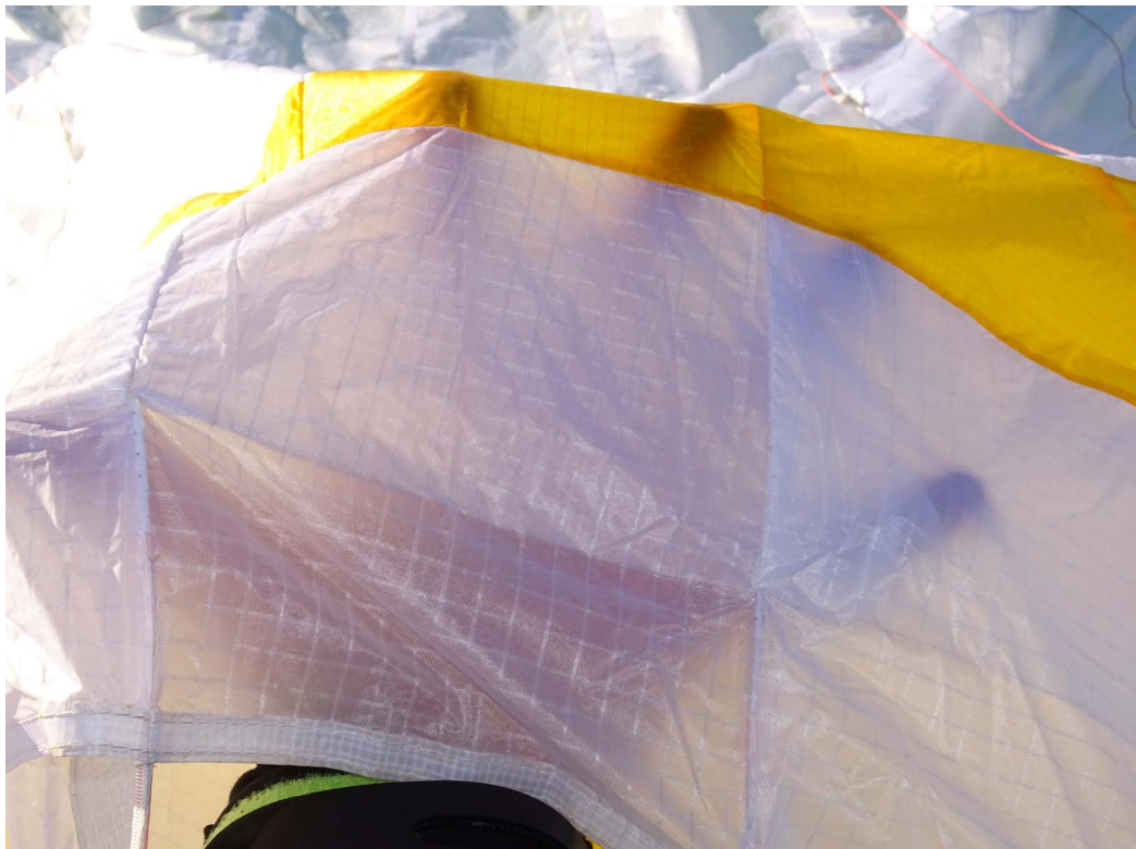
La Phantom est principalement fabriquée en Skytex 27.
