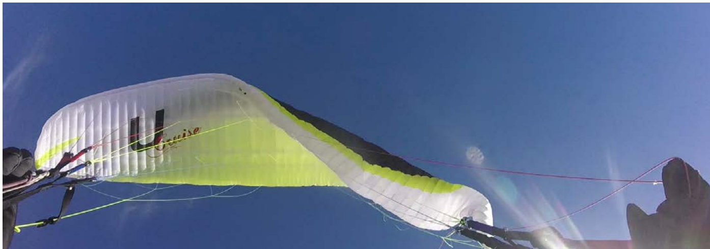
L' aile est très sage lors des fermetures faibles, prenant un peu plus d'angle après une fermeture plus importante. Photo extraite d'une vidéo : Estéban Bourroufiès
