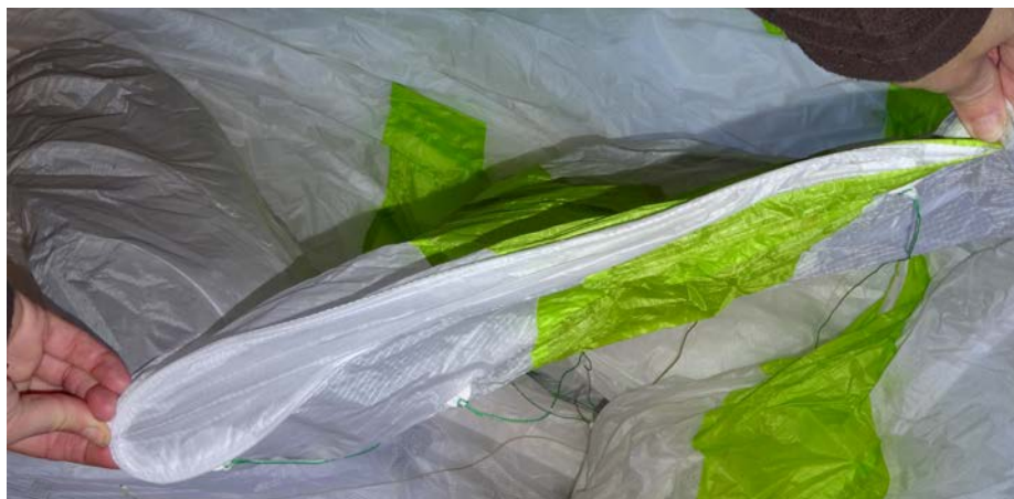
Ce curieux jonc dans le stabilo, redessinant un profil complet, a une fonction plutôt esthétique selon le constructeur. Photo : S. Burkhardt
