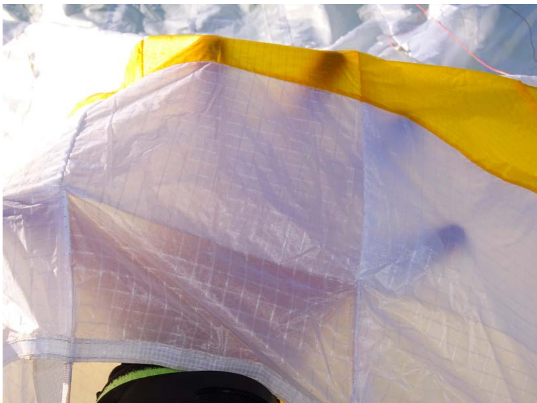
La Phantom est principalement fabriquée en Skytex 27.
