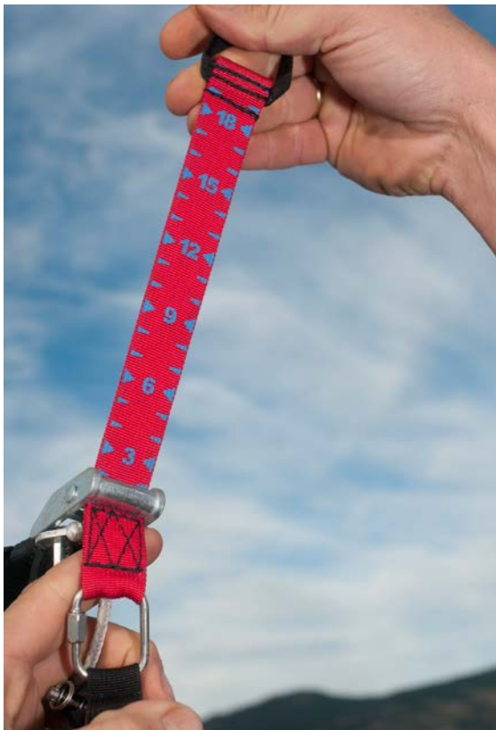
Élevateur typique pour une aile reflex efficace.
