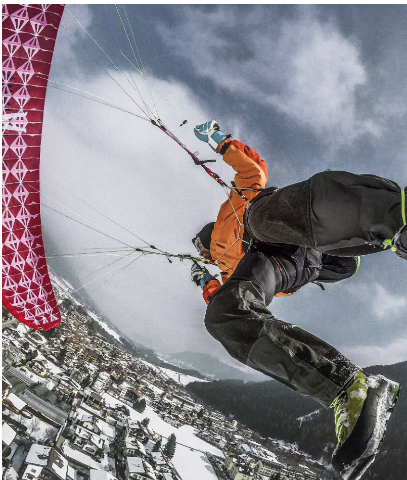
C'est chez lui ici dans le Tyrol : Skyman Markus Gründhammer. Cela fait quatre ans qu'il travaille intensément sur des ailes mono peaux. Ici, un prototype de la Sir Edmund Race, mono peau allongée de 6.01 points, 20 m 2 . L'utilisation de "cloisons" diagonales a permis de réduire les suspentes de moitié, c'est une bonne voie pour augmenter la performance de cette Single Skin. La cohérence de l'aile est également obtenue par son lobe (sa courbure en arc), mais aussi grâce à la tension générée par les deux caissons fermés en bout d'aile qui créent une tension vers l'extérieur dans le sens de l'envergure.
