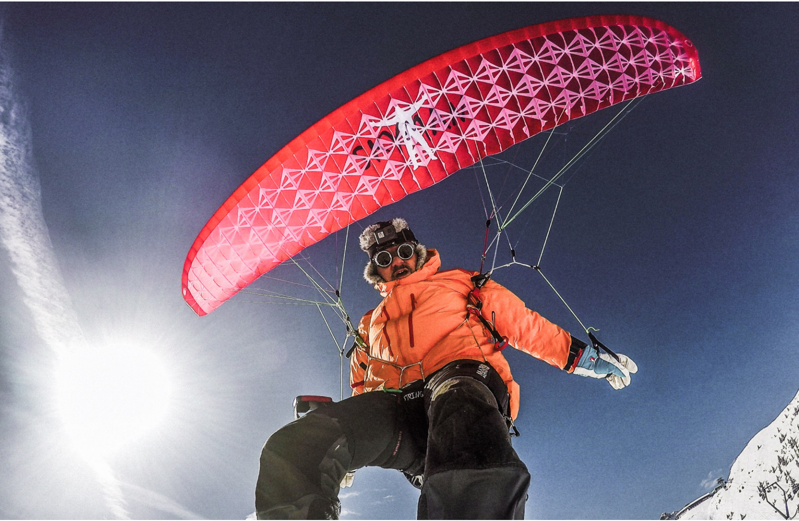
C'est chez lui ici dans le Tyrol : Skyman Markus Gründhammer. Cela fait quatre ans qu'il travaille intensément sur des ailes mono peaux. Ici, un prototype de la Sir Edmund Race, mono peau allongée de 6.01 points, 20 m 2 . L'utilisation de "cloisons" diagonales a permis de réduire les suspentes de moitié, c'est une bonne voie pour augmenter la performance de cette Single Skin. La cohérence de l'aile est également obtenue par son lobe (sa courbure en arc), mais aussi grâce à la tension générée par les deux caissons fermés en bout d'aile qui créent une tension vers l'extérieur dans le sens de l'envergure.
