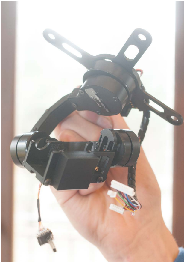
Sur le Ghost, il fallait monter nous-même la nacelle et le berceau de la GoPro. C'est intéressant et aide à bien comprendre le fonctionnement. Sur un drone comme le Phantom 4, tout est prêt, monté à l'intérieur.
