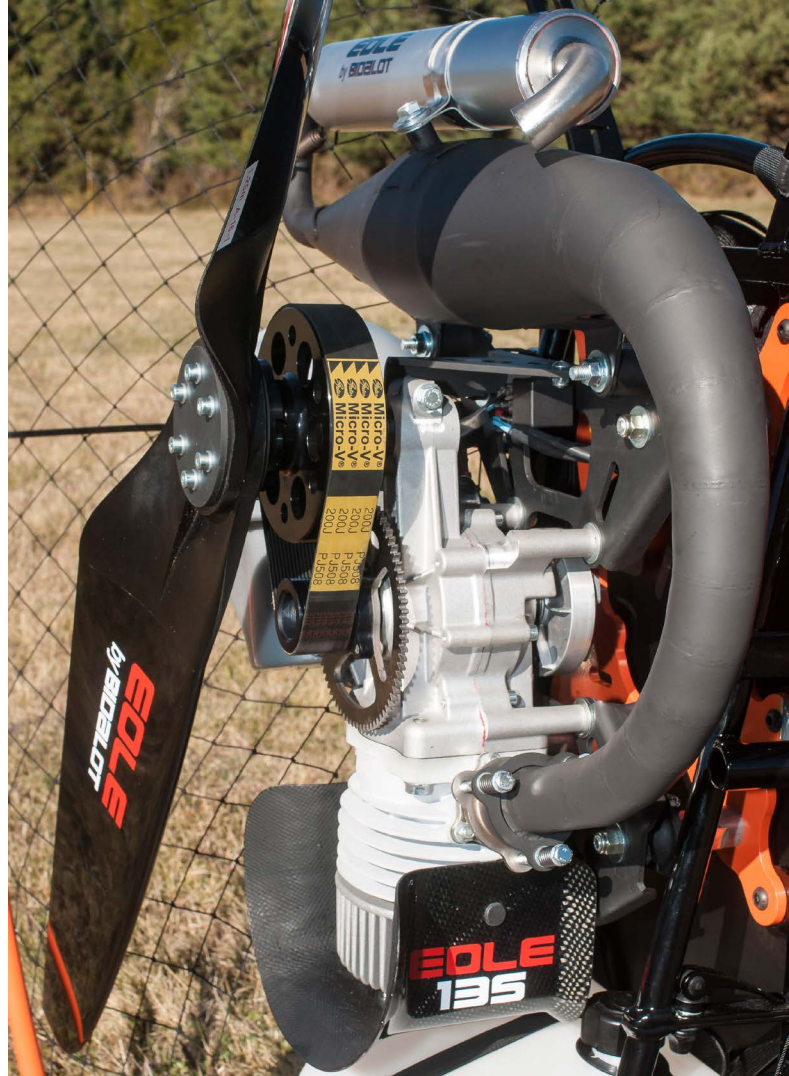
Le pot d'échappement : plus de 15 prototypes pour arriver au résultat souhaité.
