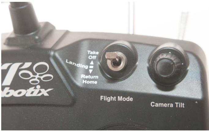
Avec le sélecteur "Flight Mode", on peut commander un retour automatique au point de départ, avec atterrissage automatique en douceur.
