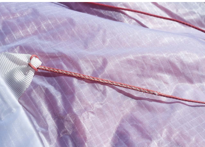
En haut, suspentes non gainées.
