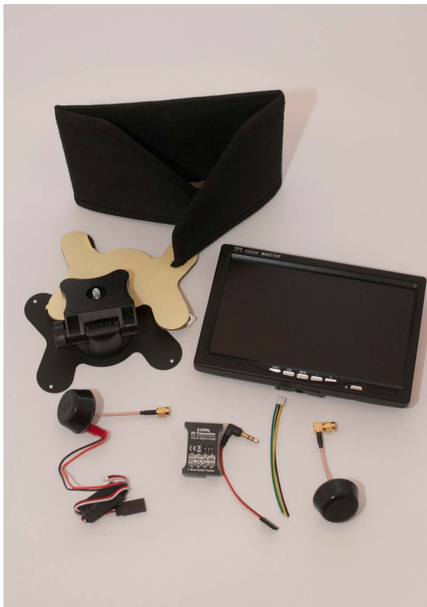
Le système FPV (First person View ou pilotage par immersion) du Ghost est basé sur un écran dédié et une transmission radio à part. Sur d'autres drones, tout est plus intégré, et c'est sur l'écran du smartphone que l'on peut observer ce que le drone voit.
