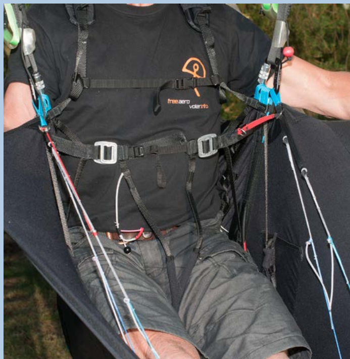
L'Advance Lightness 2 (testée par voler.info en 2015) est équipée d'un système GetUp avec deux boucles plates légères. C'est fiable!
