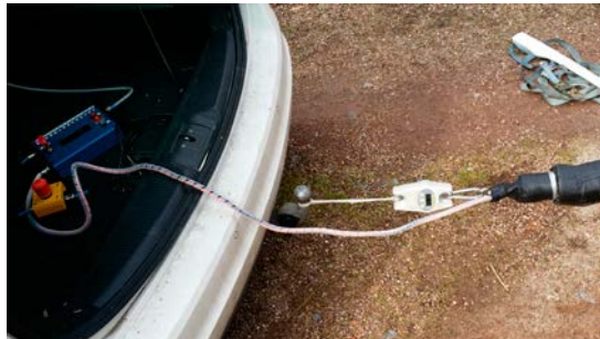
Le câble est fixé à l'attelage de la voiture (ici avec un peson pour test)
