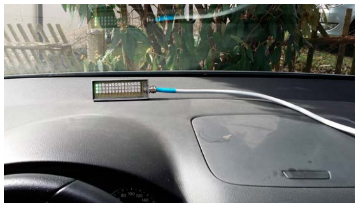
Le conducteur est informé de la force de traction par des LEDS colorées. Il suffit de régler la vitesse de manière à rester dans le vert.
