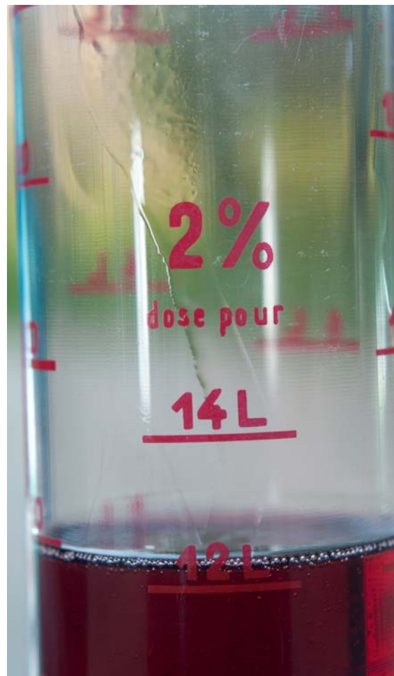
Pratique : un doseur indiquant les quantités nécessaires d'huile pour faire le bon mélange en fonction de la quantité d'essence. Le capuchon empêche les saletés de se loger dans le récipient au stockage. 13,90 €
