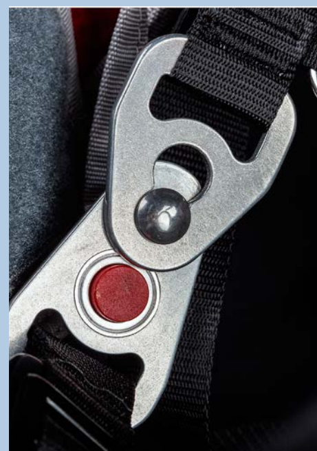
Ce genre de boucles, également produites par Finsterwalder et utilisées par plusieurs marques, ne peut pas s'ouvrir sous tension. En revanche, si le bouton lâche, la boucle peut s'ouvrir quand la sangle est lâche. Il y a eu une Safety Note concernant de rares cas où le bouton pouvait sortir de son logement.
