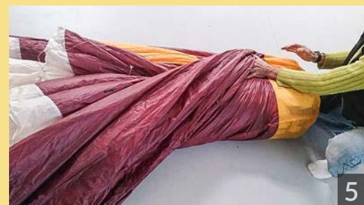
Image 4 : On replie les deux côtés l'un sur l'autre en alignant bien les 2 joncs centraux dans le même sens
