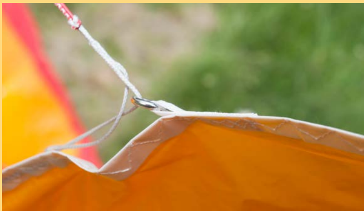
Un classique: rétrécissement du bord de fuite lors du freinage
