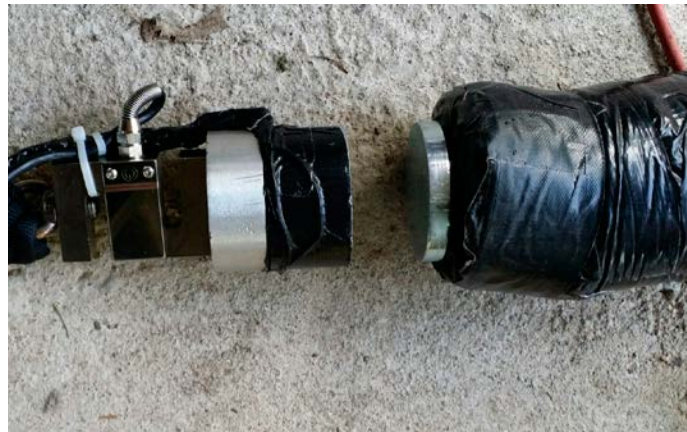
Un électroaimant coupé en cas de surcharge
