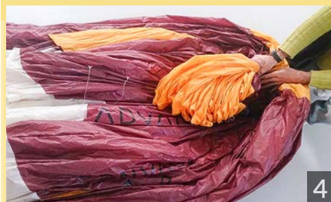
Image 3 : On bascule le bord d'attaque vers l'arrière
