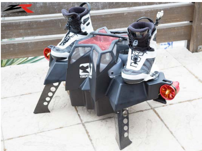
4 réacteurs au milieu pour la portance, deux autres moteurs pour le pilotage sur les côtés.
