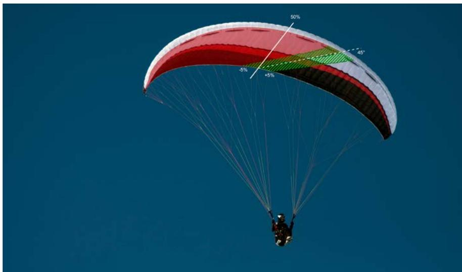
Les définitions des fermetures asymétriques à obtenir ont légèrement changé. En haut, tout ce qui est rouge doit disparaître dans la "grande" fermeture EN 2005, avec une tolérance (en vert). En bas, les fermetures anciennes et nouvelles comparées. Le principe reste le même dans la "nouvelle" EN. En revanche, elle interdit les lignes de pliage comme moyen d'y parvenir, sauf pour les EN D... Photo : Gudrun Öchsl/Profly
