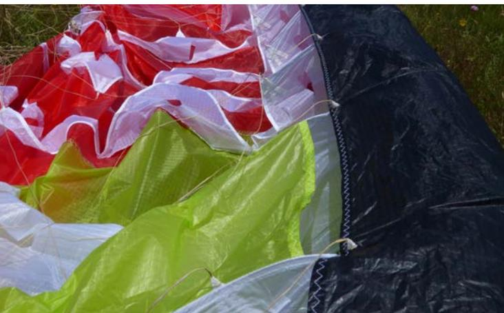
6 caissons, 4 rangées de suspentes, des joncs en métal (Nitinol) et du Skytex 27 pour cette version "Plume" de la Skin 2. La 18 pèse 2,13 kg sur notre balance. C'est un poids plume, mais 500 g de plus que la Skyman. Il existe une version encore plus "lourde": 2,5 kg en tissu Skytex 32.
