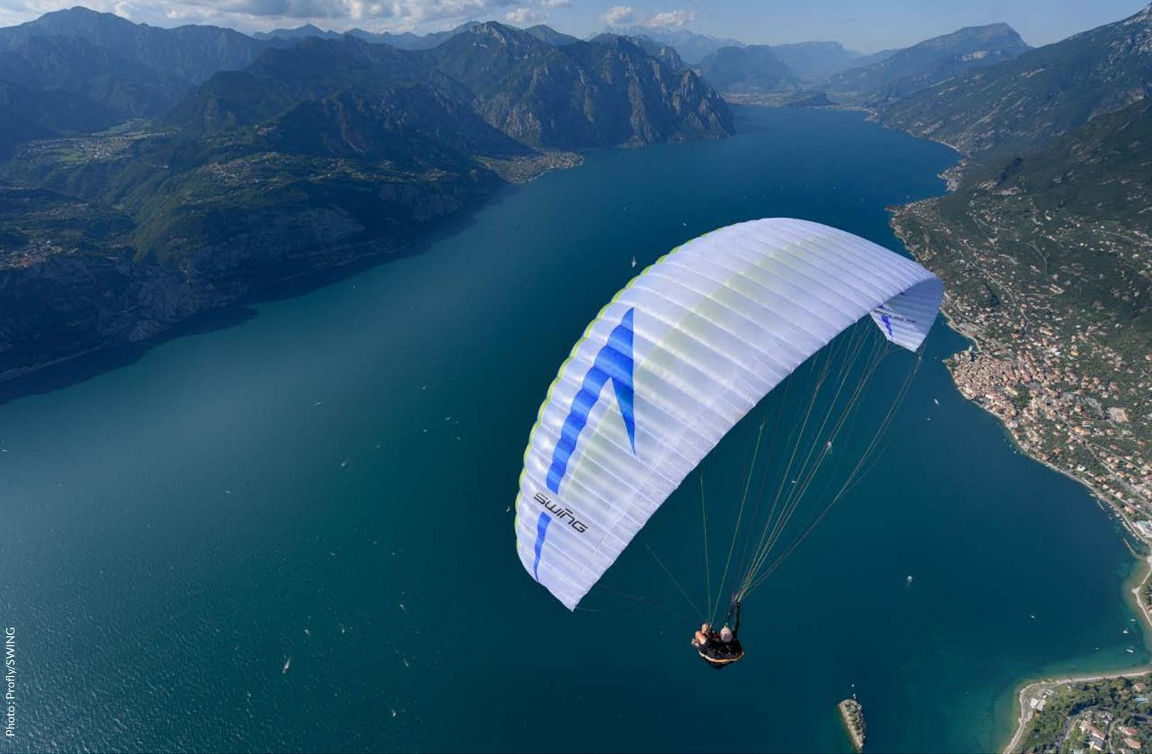
L'Arcus RS Light : la cloison RAST est bien visible au milieu de l'aile.
