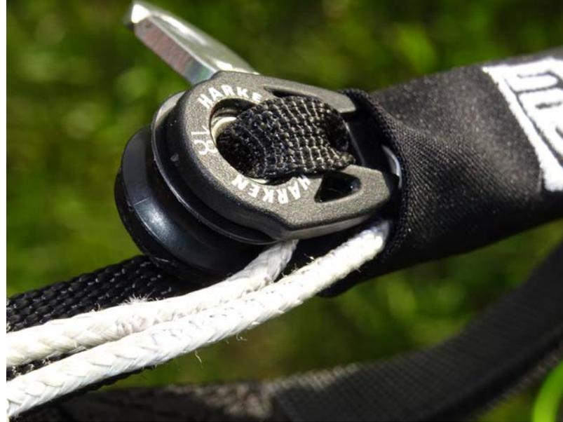
Poulie Harken retenue en place grâce à une gaine. Des détails
