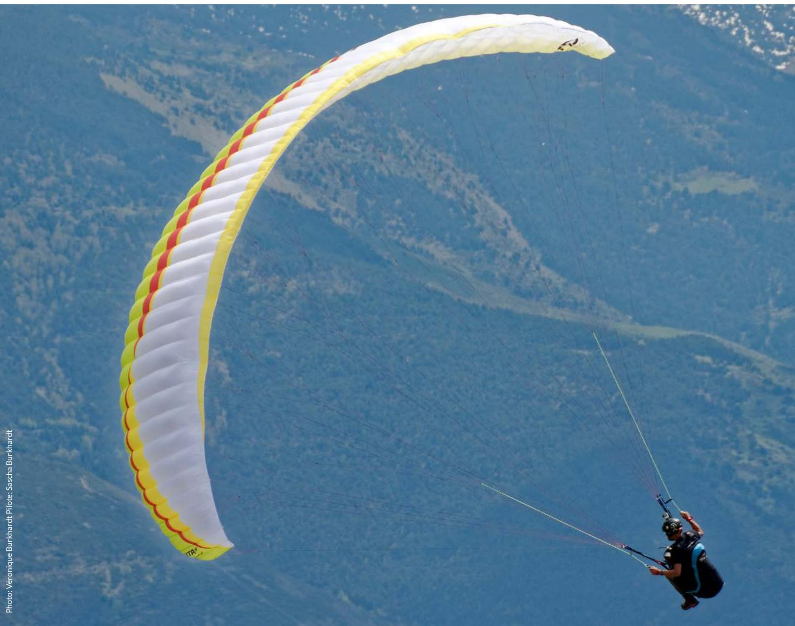
L'aile balance légèrement sur l'axe du roulis avant de finir par se stabiliser, mais elle ne shoote pas. Même en se penchant au maximum du côté fermé, la voile reste en ligne droite. Les exigences du cahier de charges au niveau de la sécurité semblent absolument atteintes.
