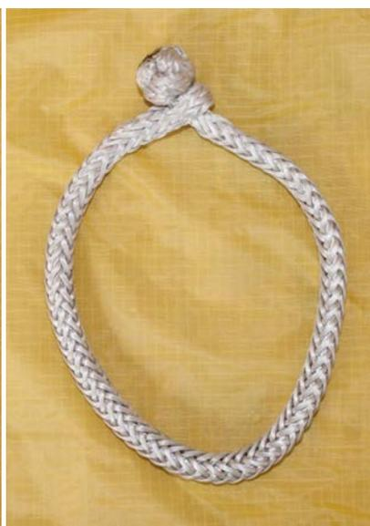
Une des pistes essayées était une boucle simple, où la tresse passe en elle-même et finit avec un nœud d'arrêt en forme de boule, le nœud de sifflet de bosco (Wikipedia :<https://goo.gl/Xq35WD>). C'est une manille textile très utilisée en nautisme.
