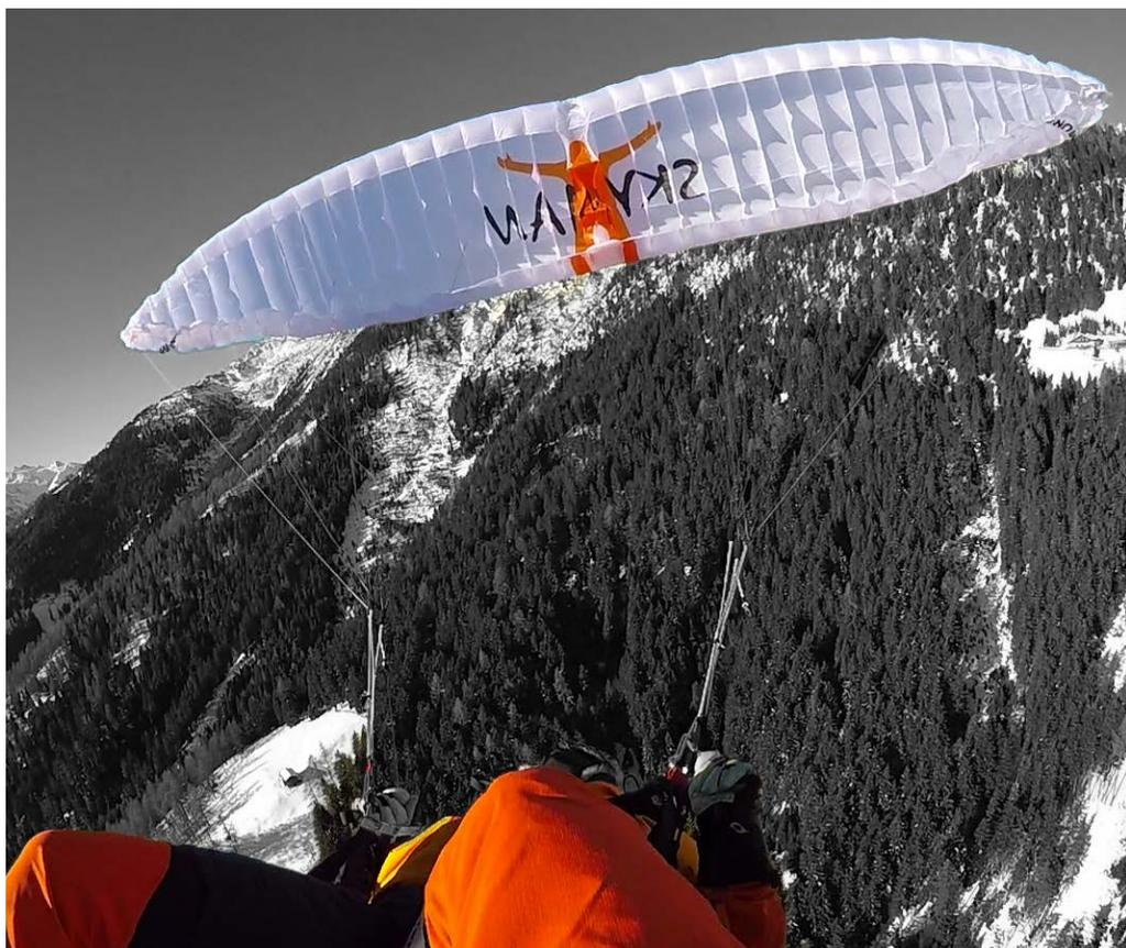
En revanche, malgré une légère augmentation de la plage de vitesses pour les derniers modèles, les profils creux peuvent toujours décrocher net si le pilote freine trop: les débutants, à qui on pourrait confier ce type d'aile, risquent de se faire surprendre. Nous avons déjà décrit tout cela en détail, l'article est toujours disponible (lien ci-contre).
