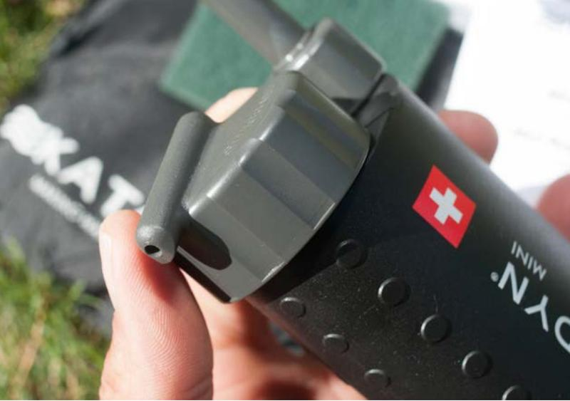
Le raccord de sortie: il devrait être un peu plus long pour mieux attacher le tuyau de sortie (qui manquait à la pompe testée).
