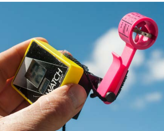
Bientôt 30 ans de bons et loyaux services : le premier anémomètre Skywatch qui nous indiquait si le vent était trop fort pour décoller avec une Brizair à 10 caissons... Photos : Sascha Burkhardt
