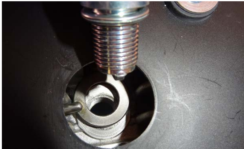
Une sonde CHT qui est fixée sous la bougie
