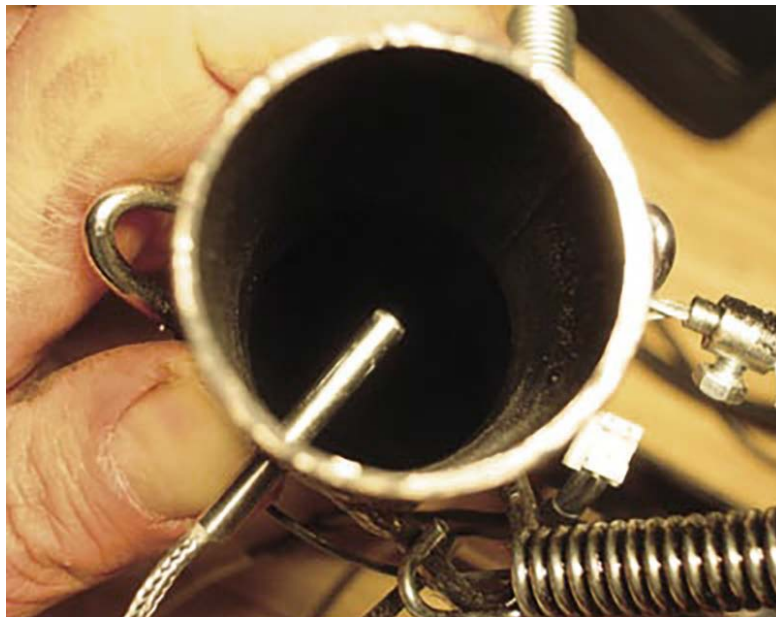
Une sonde EGT dans le pot d'échappement, près de la sortie du cylindre.
