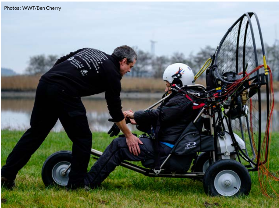
Le moteur fut fixé sur un chariot russe "Zummer", fabriqué en inox et en alu par la société Paraavis
