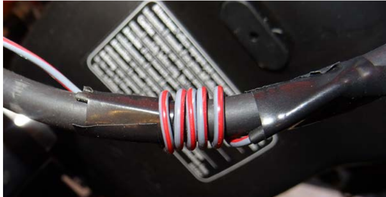
Un capteur de compte-tours: un fil autour du câble d'allumage
