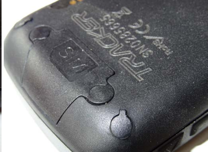
Dans le boîtier étanche, la carte SIM est déjà intégrée. On n'est pas censé d'ouvrir son logement.
