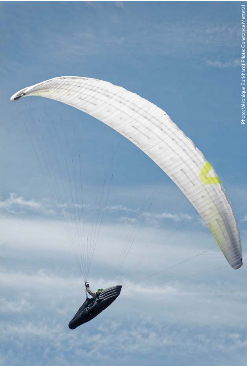
La Poison X-Alps est équipée de Jetflaps (fentes entre intrados et extrados dans la partie arrière de la corde).
