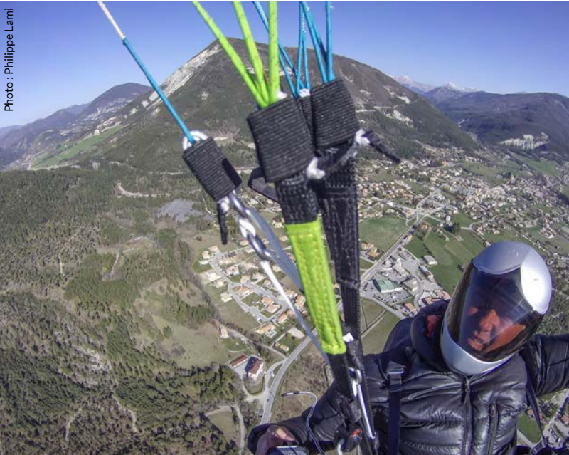
Des élévateurs en sangles, mais avec des softlinks. Photos : Philippe Lamy
