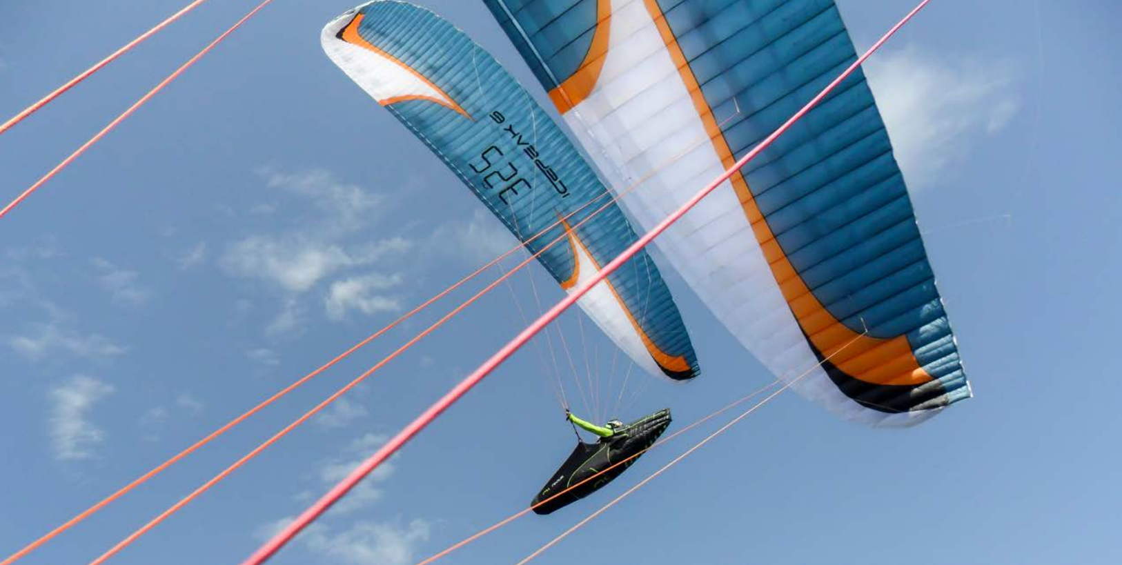
Icepeak 6 de 2012: on voit bien l'épurement du suspentage grace aux deux lignes
