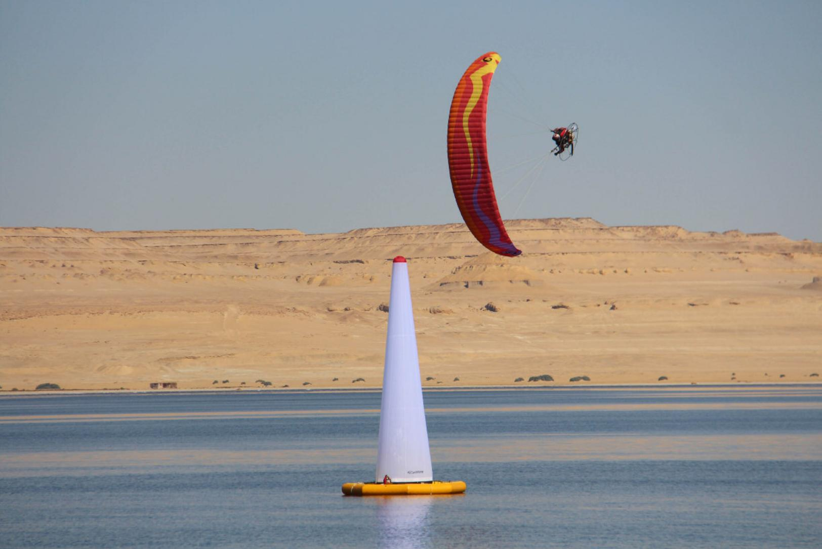
Le virage optimisé et rapide en paramoteur: tout un art, une combinaison savante d'accélérateur à pied, réglage de la poussée, freinage stabilo et freinage classique. Explications détaillées sur cette technique de vol: [http://www.voler.info/cms/contentsHTML/play\\_150/index.html?page=47](http://www.voler.info/cms/contentsHTML/play_150/index.html?page=47)
