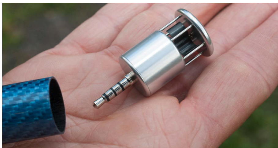
L'hélice est bien protégée dans le tube.
