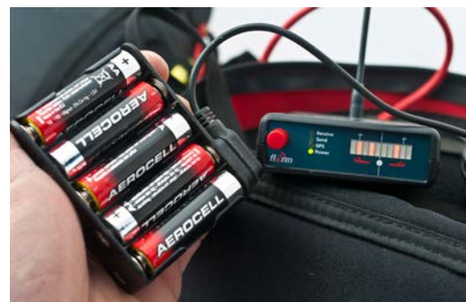
Un des premiers FLARM portable, testé par voler.info . Il fallait emporter un bloc de batteries 12 V.
