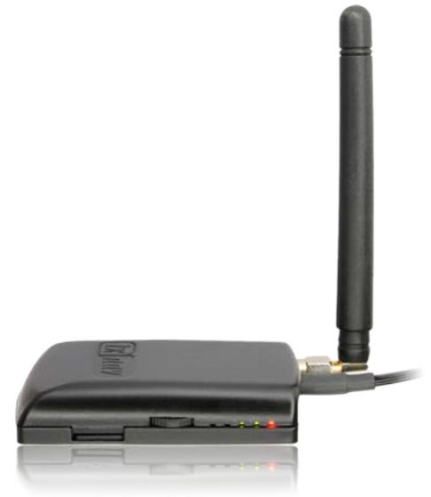
La FlarmMouse : un petit appareil FLARM avec engisteur de vol intégré, à partir de 700 €. http://www.lxnav.com/products/flarmmouse.html
