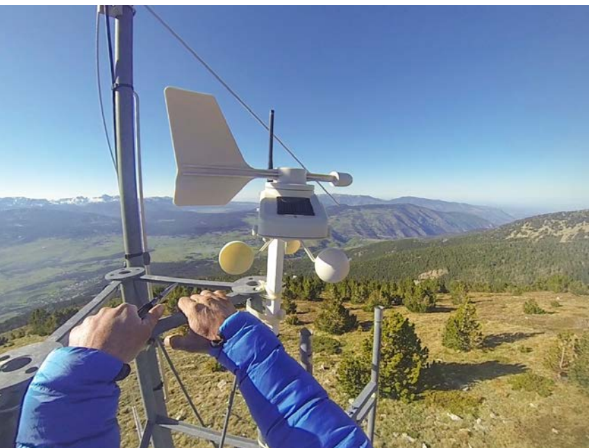
Un des premiers prototypes du PiouPiou fonctionne depuis un an sans problème de transmission à 2 400 mètres d'altitude, jour et nuit. Par contre, les coupelles ont dû être remplacées. À droite : l'électronique "made in France" n'a jamais fait défaut.
