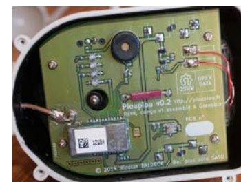
Un des premiers prototypes du PiouPiou fonctionne depuis un an sans problème de transmission à 2 400 mètres d'altitude, jour et nuit. Par contre, les coupelles ont dû être remplacées. À droite : l'électronique "made in France" n'a jamais fait défaut.
