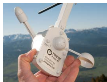
Un des premiers prototypes du PiouPiou fonctionne depuis un an sans problème de transmission à 2 400 mètres d'altitude, jour et nuit. Par contre, les coupelles ont dû être remplacées. À droite : l'électronique "made in France" n'a jamais fait défaut.
