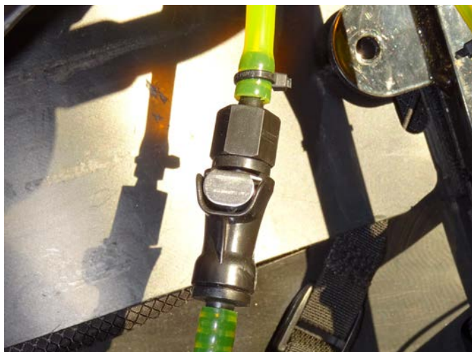
Accessoire conseillé : un connecteur rapide (env. 19 €) entre le réservoir et le moteur. Également disponible chez Reuter.
