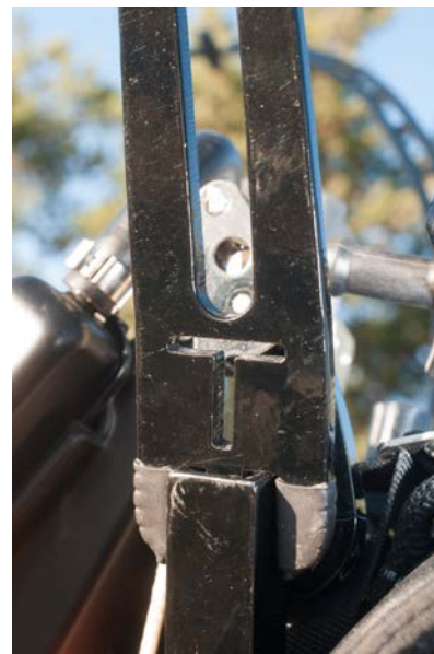
Les rayons de la cage sont clairement marqués (S = "Side", T = "Top")
