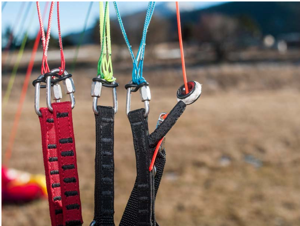
Des Maillons rapides classiques et des élévateurs à sangles classiques, mais plus étroites. L'avantage par rapport aux élévateurs Dyneema, encore plus légers : les classiques sont plus faciles à manier. Photos : Burkhardt
