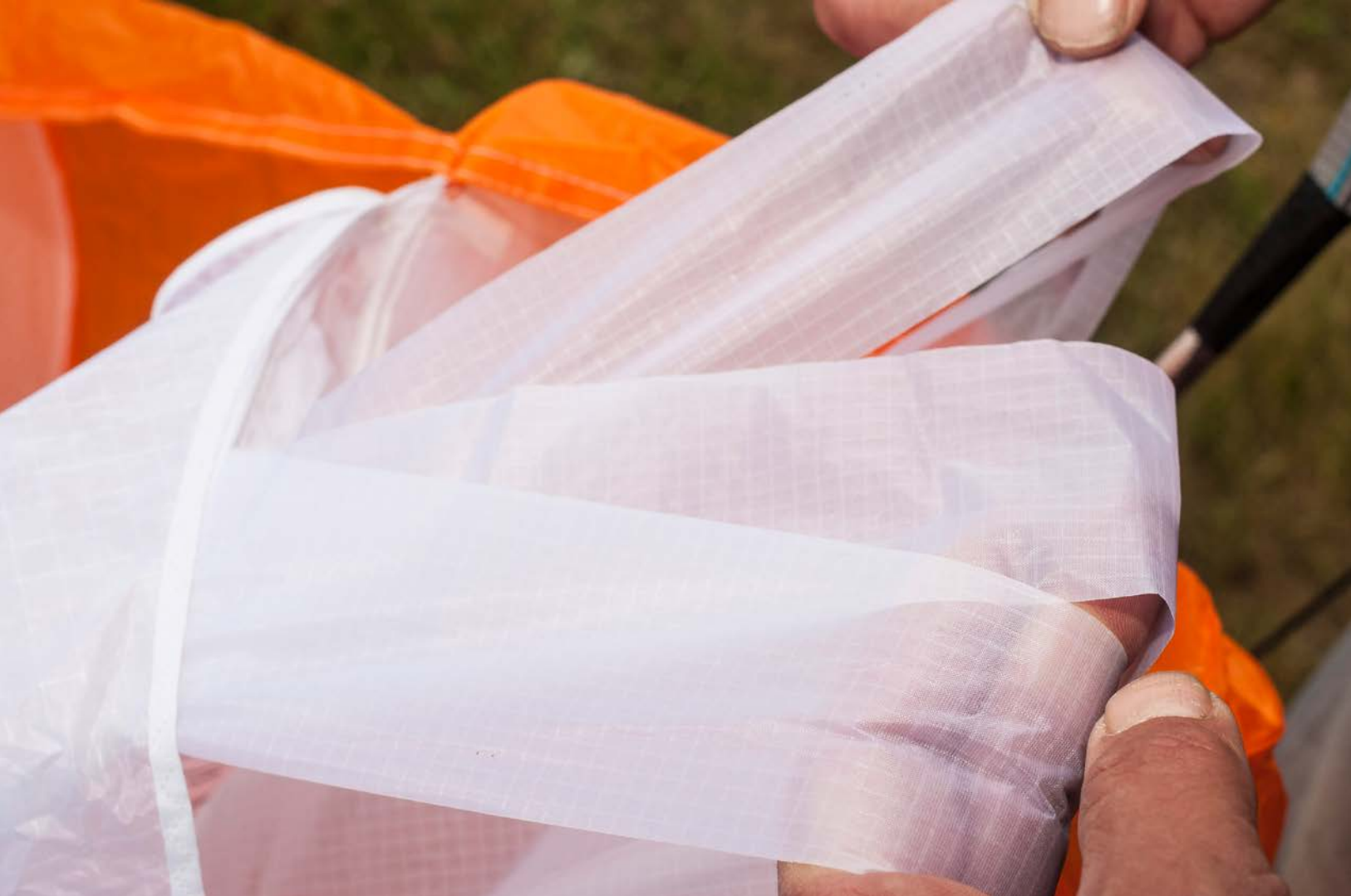
Les fameux Sliced Diagonals. À la place d'un morceau de tissu unique pour les diagonales, celles-ci sont constituées de fines bandes orientées dans le sens de la traction. Cela allège la voile, et pourrait permettre une meilleure longévité des formes. Photos : S. Burkhardt
