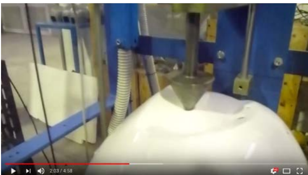
Video: The EN 966 test of an Icaro 2000 helmet. https://youtu.be/Oq0BrxVgjEM
