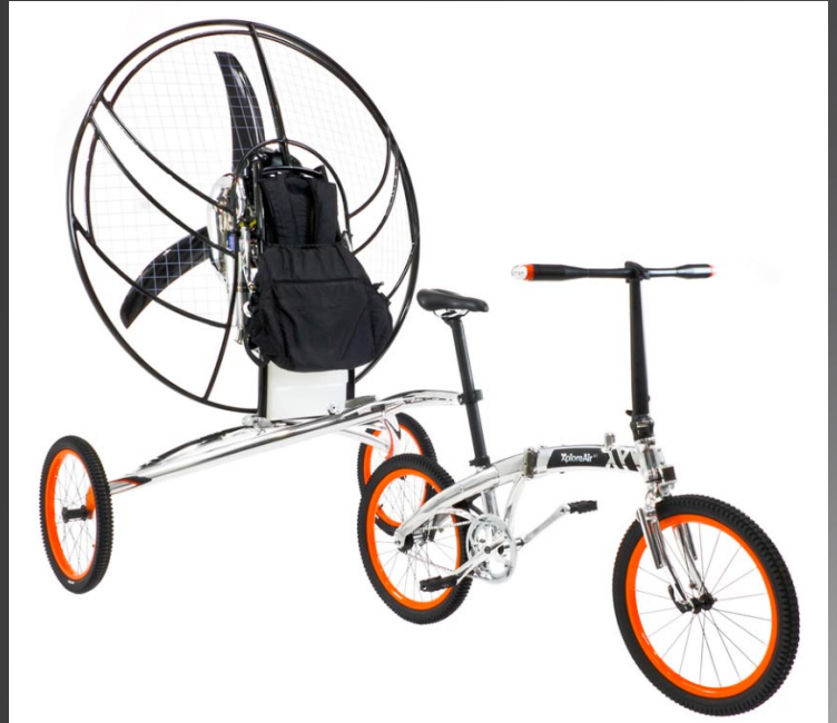
À gauche en mode "vol", à droite en mode "route". Dans ce dernier, ce vélo est très proche d'une bicyclette classique, avec une remorque en plus.
