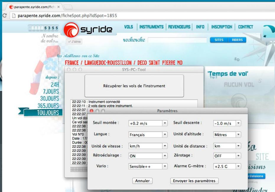
Le logiciel Sys-PC-Tool permet la configuration des instruments Syride ainsi que la récupération des vols enregistrés. Il appelle automatiquement le navigateur Internet du système pour téléverser les vols et pour télécharger des configurations d'écran.
