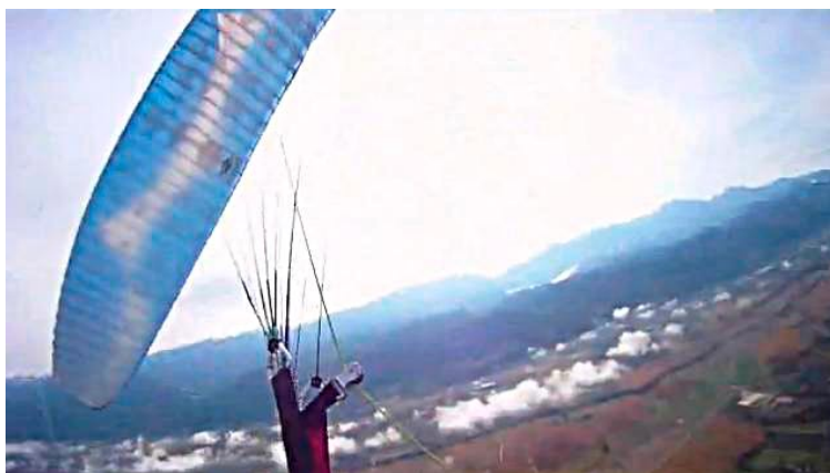
L'aile droite est maintenant complètement décrochée.
