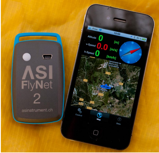
Le Flynet se connecte via Bluetooth à un iPhone ou un iPad aussi bien qu'à un smartphone ou une tablette Android. Cet instrument apporte ainsi une sonde barométrique très précise à ces mini-ordinateurs.
