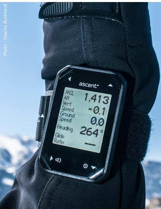
Comme la plupart des instruments, au décollage, l'Ascent cale son altimètre barométrique sur le GPS. L'altitude affichée pendant le vol reste assez près de la hauteur réelle au-dessus du niveau de la mer, sauf en cas de changement significatif de la météo...
