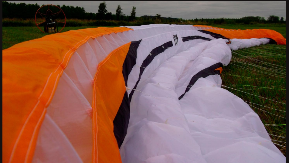
Joncs au bord d'attaque, entrée d'air de faible surface, suspentes fines, pas de doutes, nous sommes bien face à une aile de dernière génération
